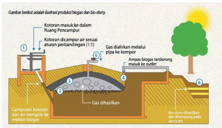
Ilustrasi unit biogas/reaktor BIRU © 2012 Hivos
